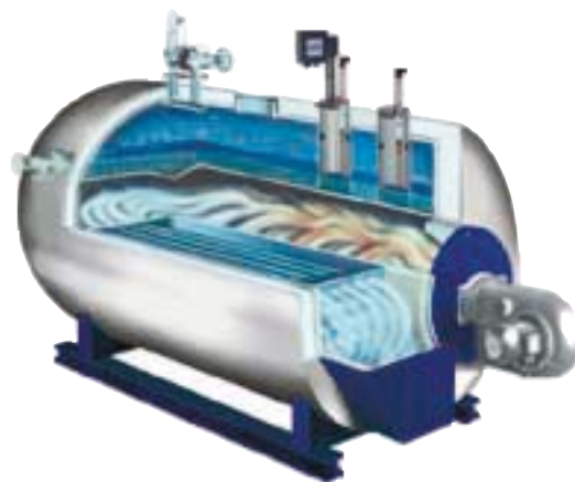
Трехходовой принцип котла UL-S
